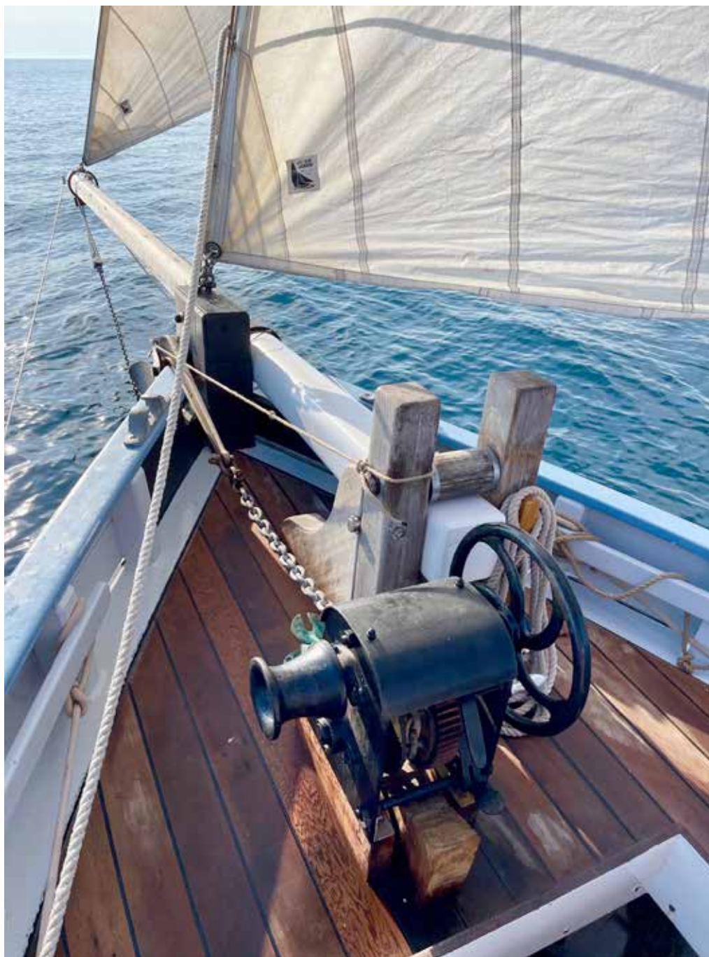
Un guindeau traditionnel de fabrication allemande a été ajouté.
